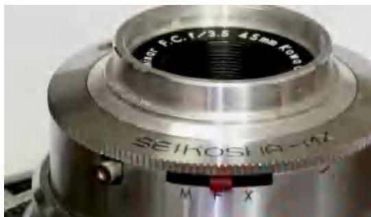
格拉福“世纪35”相机的快门上有单次闪光同步和万次闪光的档位。
