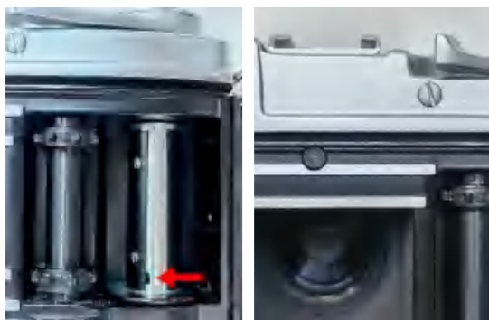
带有快速挂片孔钩的收片轴。
