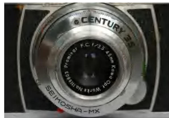
格拉福“世纪35”相机使用的柯瓦45mm F3.5镜头
