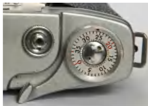
力矩式输片结构上的经典盘式计数器。
