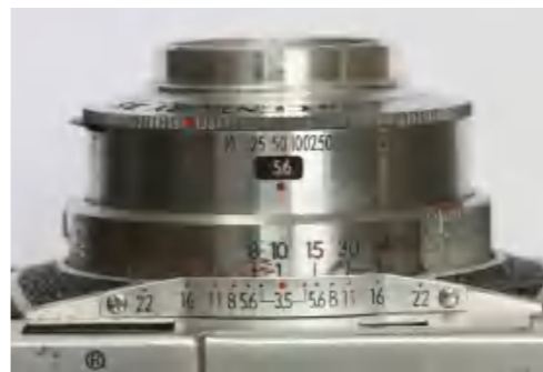
格拉福“世纪35”相机的快门速度、光圈调节和景深指示表。标有红色的 1/50 秒、15 英尺和 f/11 形成了超焦距挡。
